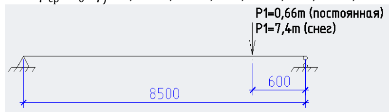
Рисунок 13. Расчетная схема для правого швеллера 30П
